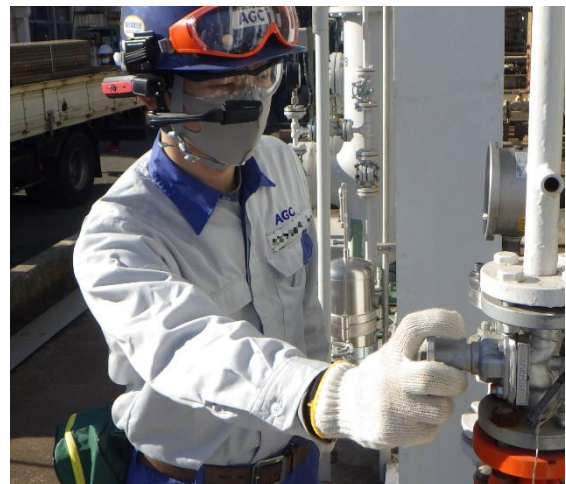
スマートグラスを活用したオペレーター業務（イメージ）
